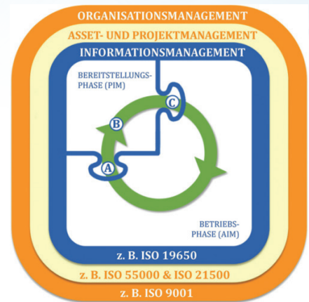
Abbildung 4: Die „Onion“ der ISO 19650 erklärt die grobe Hierarchie der Normen, die sich mit dem Lebenszyklus eines Assets beschäftigen. An den Stellen A, B und C werden Informationsmodelle (IM) übergeben 2 (Quelle: der Autor).
