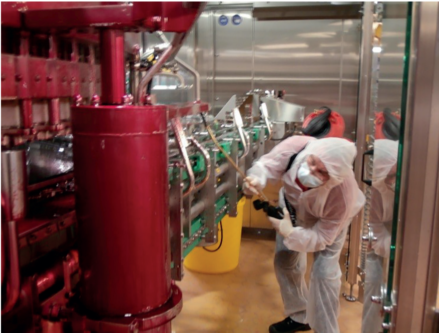
Abbildung 3: Auftragen des GIR-Retentionstest-Mediums zur Durchführung des Spritzschattentests an einer Abfüllanlage (Quelle: GIR – The German Institute of Rehygienization GmbH).
