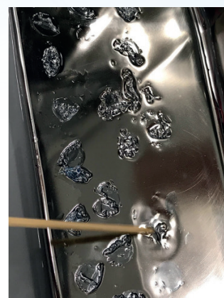
Ablösung von Silikonverunreinigungen mittels BERA-GC RL1.
